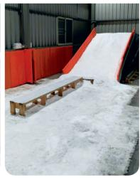
於摩擦力的克服,讓在仿真雪上滑雪感覺像在真雪上那麼順暢。過程中經歷滑雪板介面的改造研究、滑雪板專業製造公司的取經、安全設計、滑雪道的規劃等。眼看著研究進度卡住了,團隊決定重新審視各個因子,把實驗資料再翻看一次,找出了原本受限經費而刪除的材料加碼做一次看看,竟然在滑行數據的表現超乎預期的好。滑雪板介面研究、安全設計、滑雪道設計三者到了結案前最後半個月方才整合在一起,還好有台灣滑雪好手們的協助實測,總算在結案期限前達成目標。
