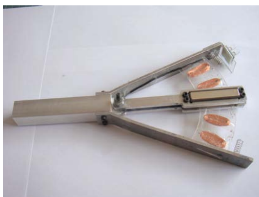
鋁合金製作之震動發電機構發光裝置
