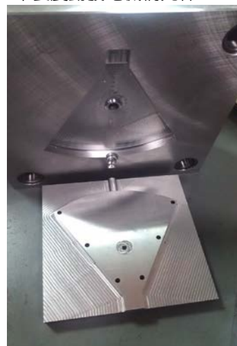
具震動發電機構發光裝置之元件量產模貝
