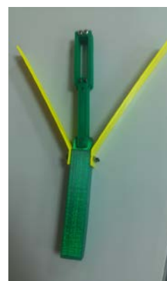
3D Printer印製震動發電機構元件
