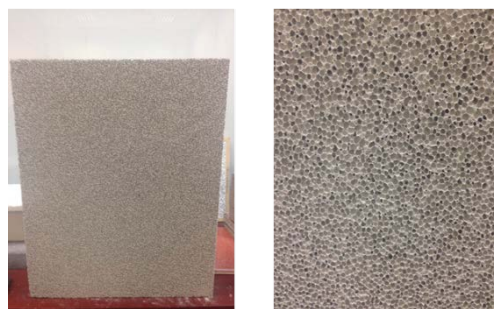
發泡玻璃材料成品之巨觀與微觀照片
